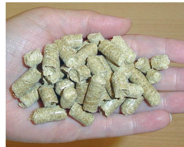
Pellets de madera, forma de biomasa granulado para uso en calderas automatizadas.
